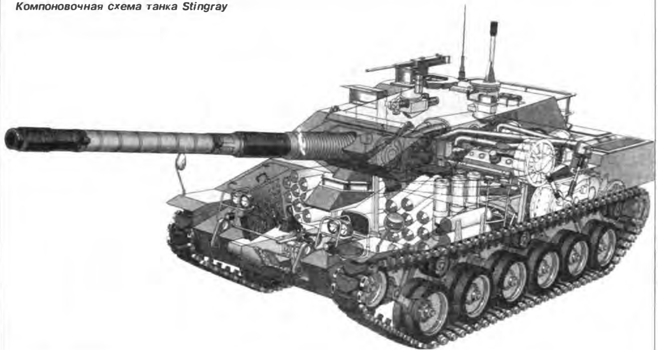
Компоновочная схема танка Stingray
