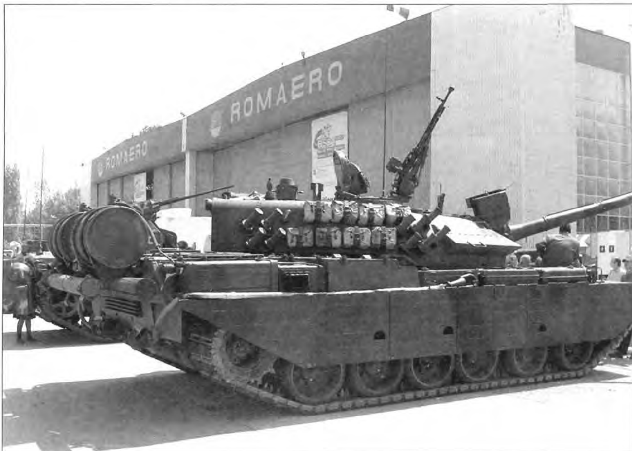
Основной боевой танк TR-85M1 Vizopul (вверху). Хорошо видна форма башни с развитой кормовой нишей, дымовые гранатометы, сблочные экраны. Башня танка TR-85M1 Vizopul крупным планом (справа). Над стволом пушки установлен лазерный дальномер. Танк TR-85M1 Vizopul во время демонстрационных заездов (на стр. 289)
