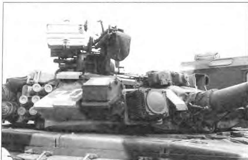
Башня танка Т-90 крупным планом. Хорошо видны элементы СО-ЭП «Штора», дымовые гранатометы системы «Туча» и блоки КДЗ «Контакт-5» (слева и внизу)
