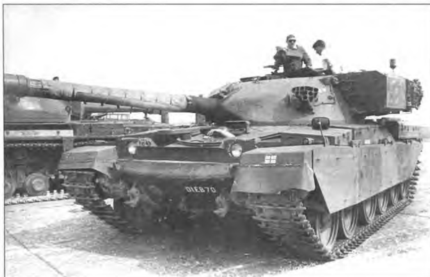
Танк Chieftain Mk 9 с башней, развернутой на «шесть часов» (вверху). Массивный контейнер на левом борту башни танка Chieftain Mk 9 — броневой кожух ИК-проектора (слева)
