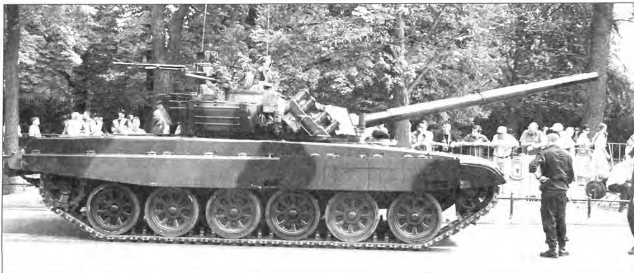
Основной боевой танк PT-91 перед парадом. Варшава, август 2007 года (вверху и слева). Хорошо видны асфальтоходные гусеницы
