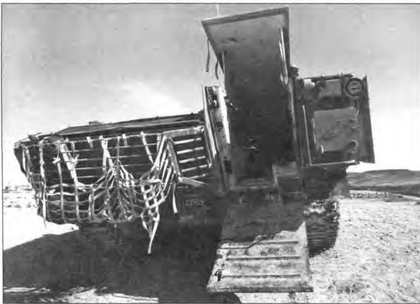
Бронетранспортер Achzarit (вверху). Вид сзади на БТР Achzarit с откинутой рампой и приподнятой крышей над проходом для десанта (слева)
