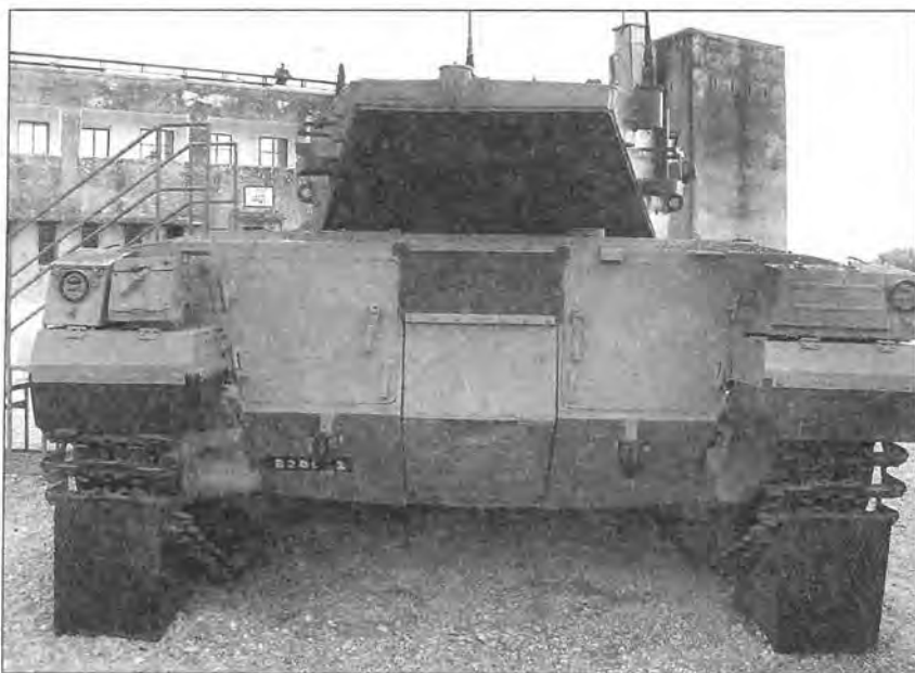
Вид сзади на танк Merkava Mk 1. Хорошо видна дверь в кормовом листе корпуса
