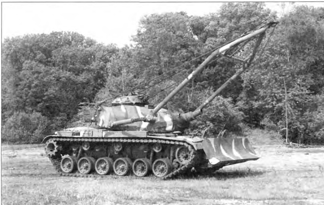
Саперный танк М728 (вверху). 165-мм орудие М135, установленное в башне саперного танка М728 (справа)
