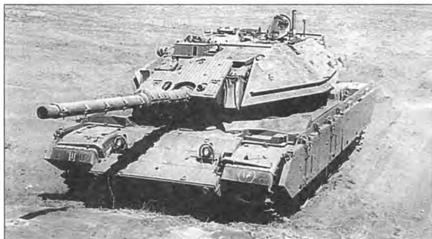
Magach-6 Bet Gal Batash — первый вариант израильской модернизации танка M60 с использованием мощной дополнительной пассивной бронезащиты
