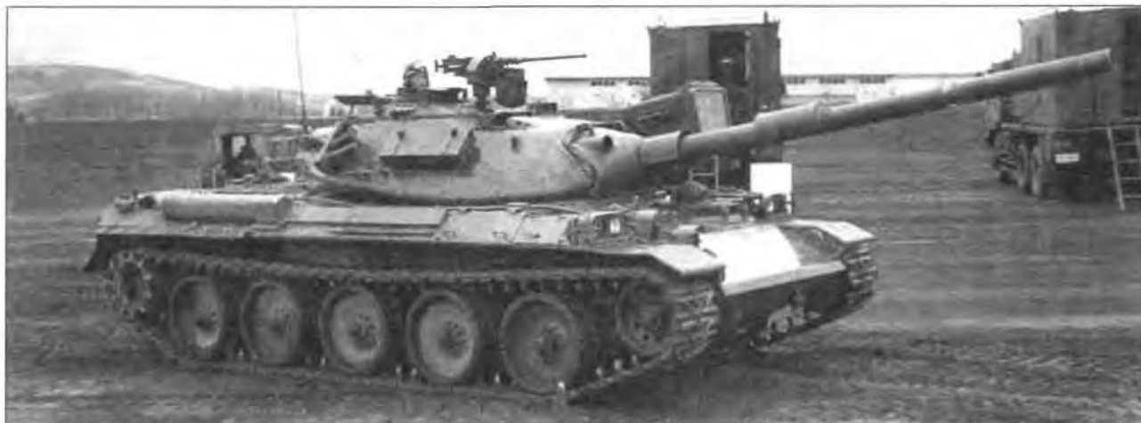
Основные боевые танки «74» во время учений. У танка на фото справа не установлен ИК-осветитель ночного прицела
