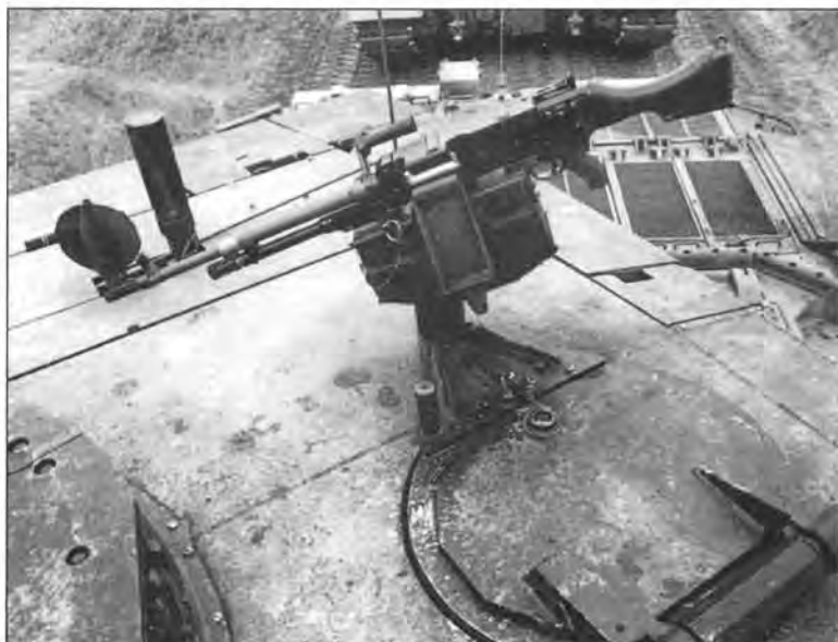
Установка пулемета на люке заряжающего, использовавшаяся на серийных танках Challenger 2
