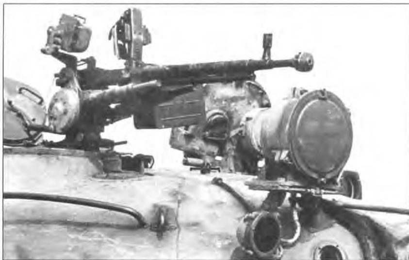
Средний танк Т-62 выпуска после 1972 года (вверху). Зенитный пулемет ДШКМ, установленный на люке заряжающего танка Т-62 (справа)
