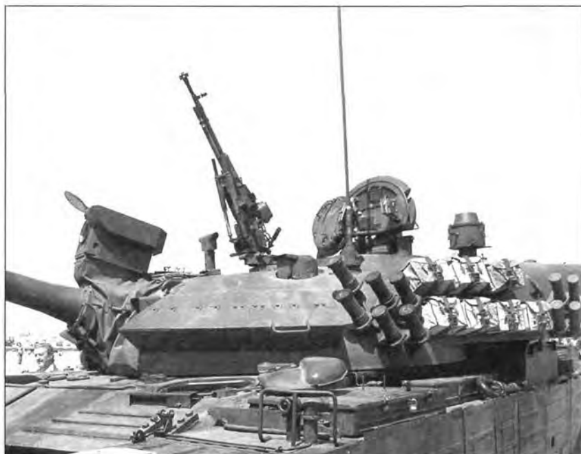
Основной боевой танк TR-85M1 Vizopul (вверху). Хорошо видна форма башни с развитой кормовой нишей, дымовые гранатометы, сблочные экраны. Башня танка TR-85M1 Vizopul крупным планом (справа). Над стволом пушки установлен лазерный дальномер. Танк TR-85M1 Vizopul во время демонстрационных заездов (на стр. 289)
