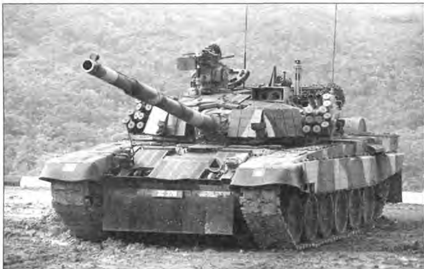
Основные боевые танки PT-91M вооруженных сил Малайзии во время подготовки и проведения боевых стрельб (слева и на стр.195). Обращают на себя внимание грязевые щитки, конструкция которых заимствована не у Т-72, а скорее у Т-80
