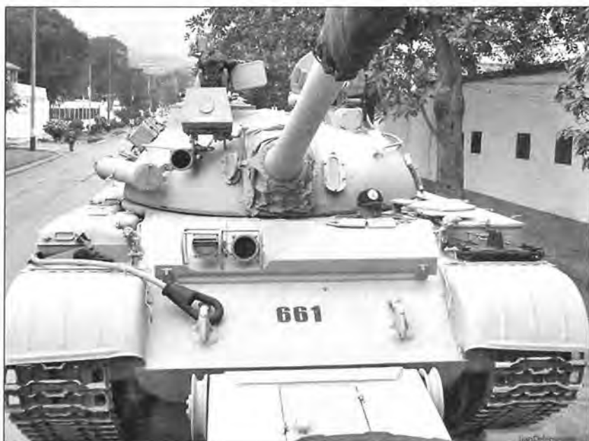
Средние танки Т-55 перуанской армии. Вверху — танк оснащен лазерным дальномером неизвестного типа, внизу — на танках в качестве дополнительного вооружения установлены ПТУР 9М14М «Малютка»
