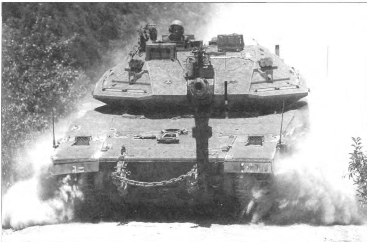
Основной боевой танк Merkava Mk 4. Хорошо видна измененная форма крыши МТО (вверху). На виде сзади (слева) обращает на себя внимание открытая кормовая дверь
