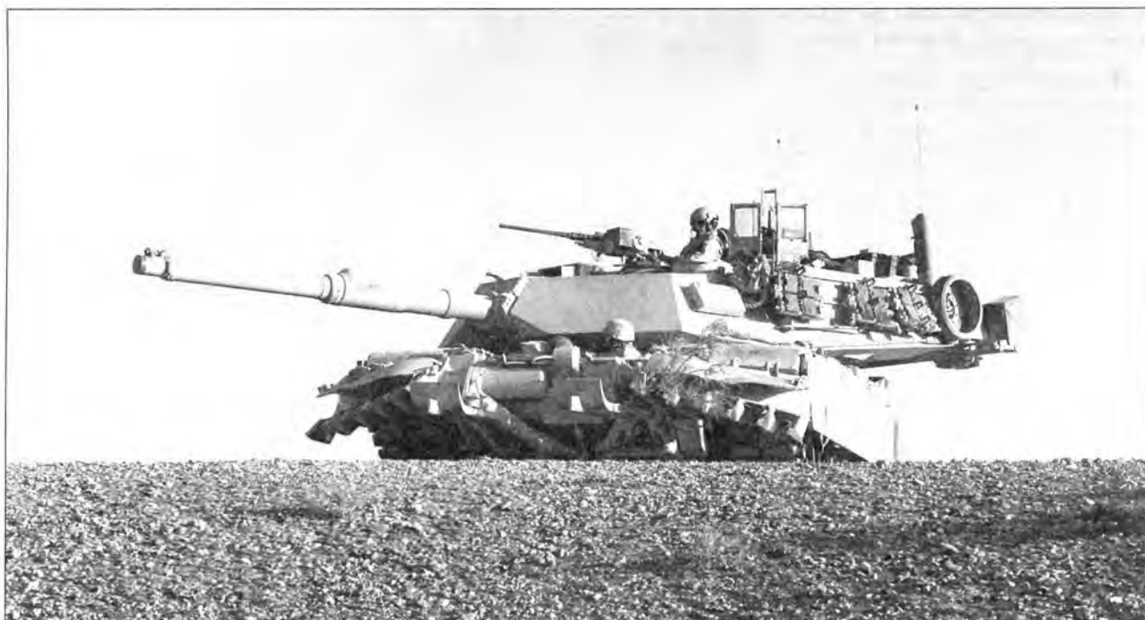
Танки Abrams в Ираке. M1A1 с колейным ножевым минным тралом (вверху). M1A2 в патруле на улице иракского города. Обращает на себя внимание щит пулемета, выполненный из бронестекла (внизу)
