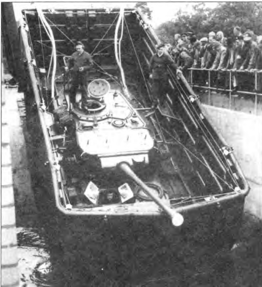
Демонстрация плавательных возможностей танка Centurion Mk 3, оборудованного складным водонепроницаемым кожухом для преодоления водных преград вплавь
