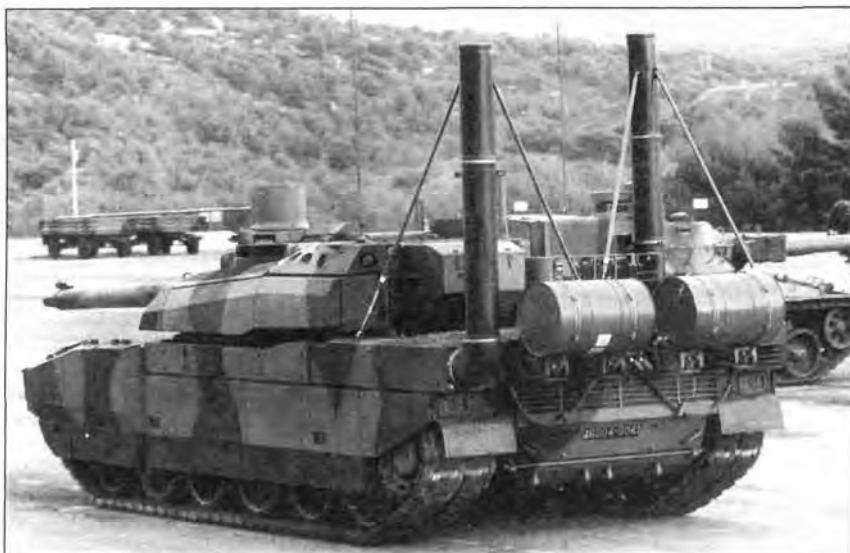
Танк Leclerc с установленным оборудованием подводного вождения (слева)
