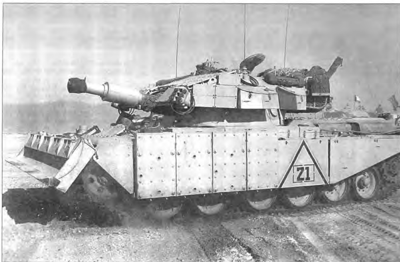
Последней боевой операцией, в которой пришлось участвовать «центурионам» британской армии стала «Буря в пустыне» в 1991 году. В ней принимали участие саперные танки Centurion AVRE (на фото) и БРЭМ Centurion (Mk 2) ARV. Машины обоих типов накануне операции получили комплекты навесной бронезащиты
