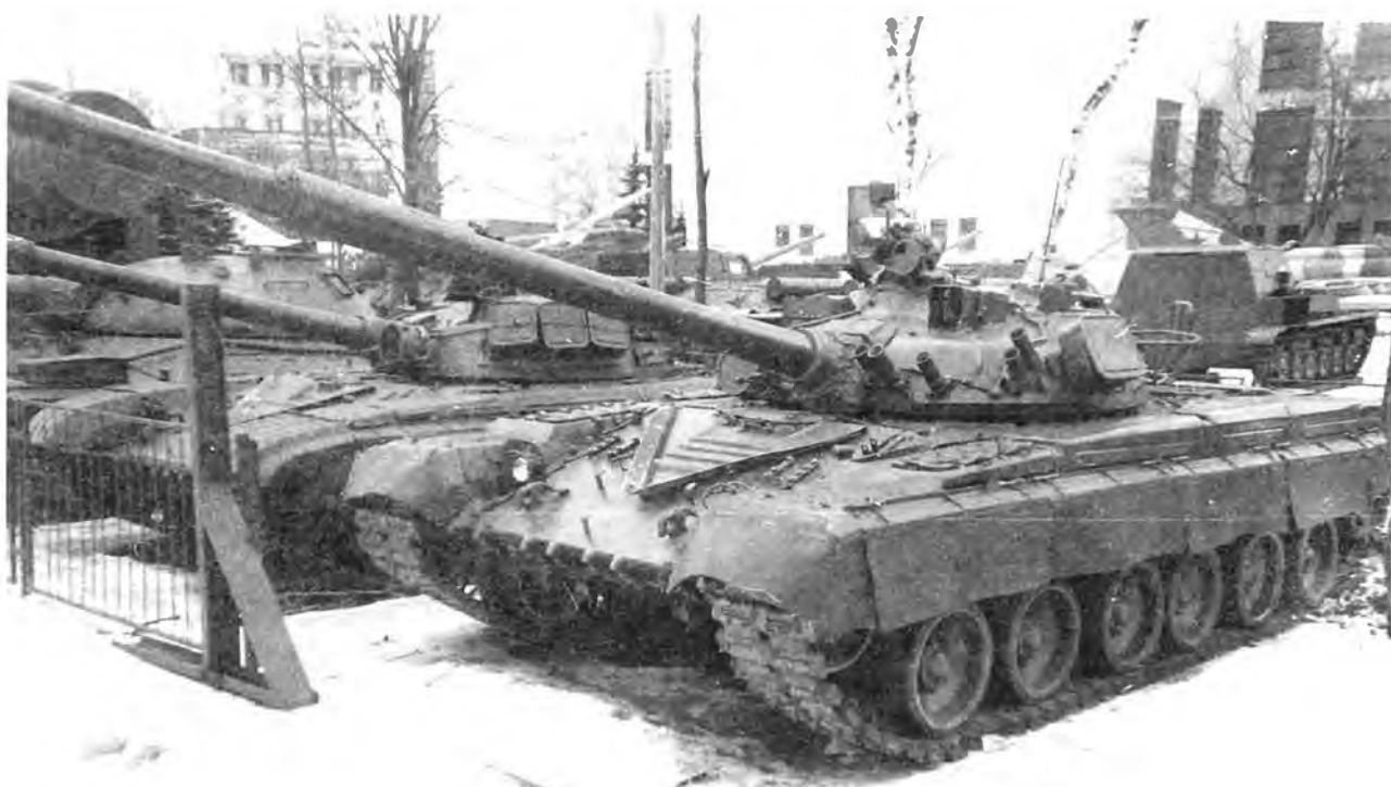
Т-80Б в экспозиции Центрального музея Вооруженных сил в Москве (вверху). Башня танка Т-80Б спереди слева. Хорошо видны ИК-осветитель Л-4А, дымовые гранатометы, антенный блок ГН-12 КУВ «Кобра» и амбразура спаренного пулемета ПКТ (справа)
