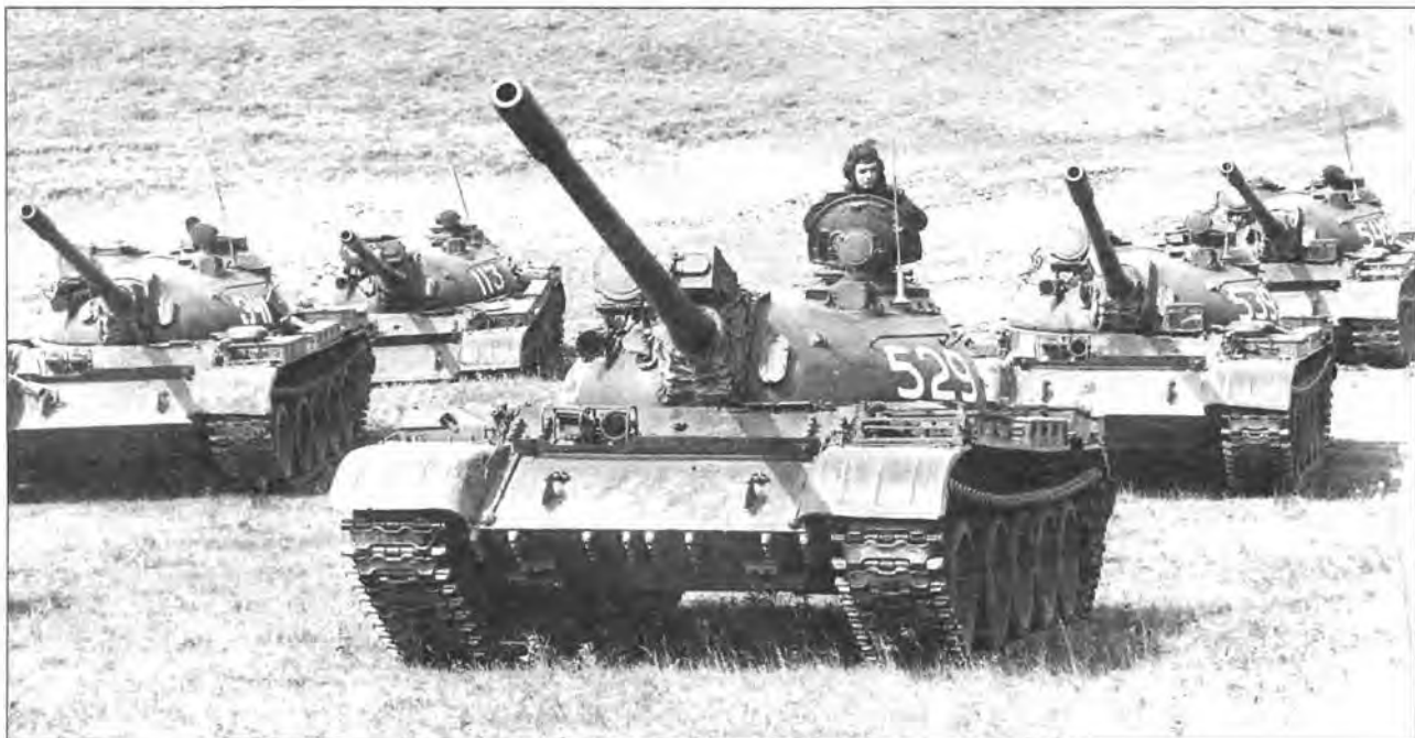
Средние танки Т-55 и Т-55А. Некоторые машины оборудованы лазерными дальномерами КДТ-1
