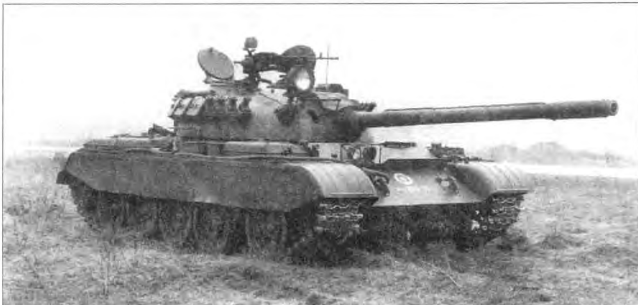
Средний танк Т-55, модернизированный в Финляндии. 1989 год. На машине установлена СУО FCS-FV/K, дымовые гранатометы, резиноканевые экраны, теплоизоляционный чехол пушки, пулемет НСВТ и гранатомет Vofors Lyran для стрельбы осветительными гранатами
