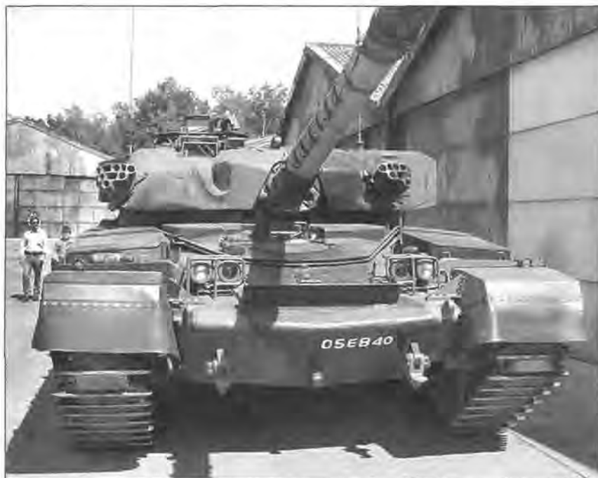
Танк Chieftain Mk 11, вид спереди. Хорошо видны элементы накладной броневой защиты Stillbrew на верхнем лобовом листе корпуса и лобовой части башни
