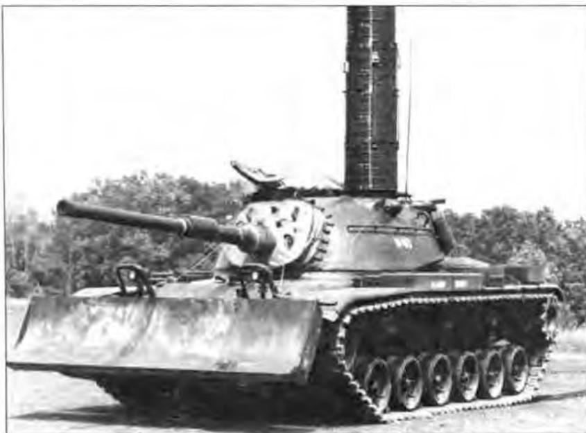
Основной боевой танк M60, оснащенный бульдозерным отвалом и трубой-лазом ОПВТ
