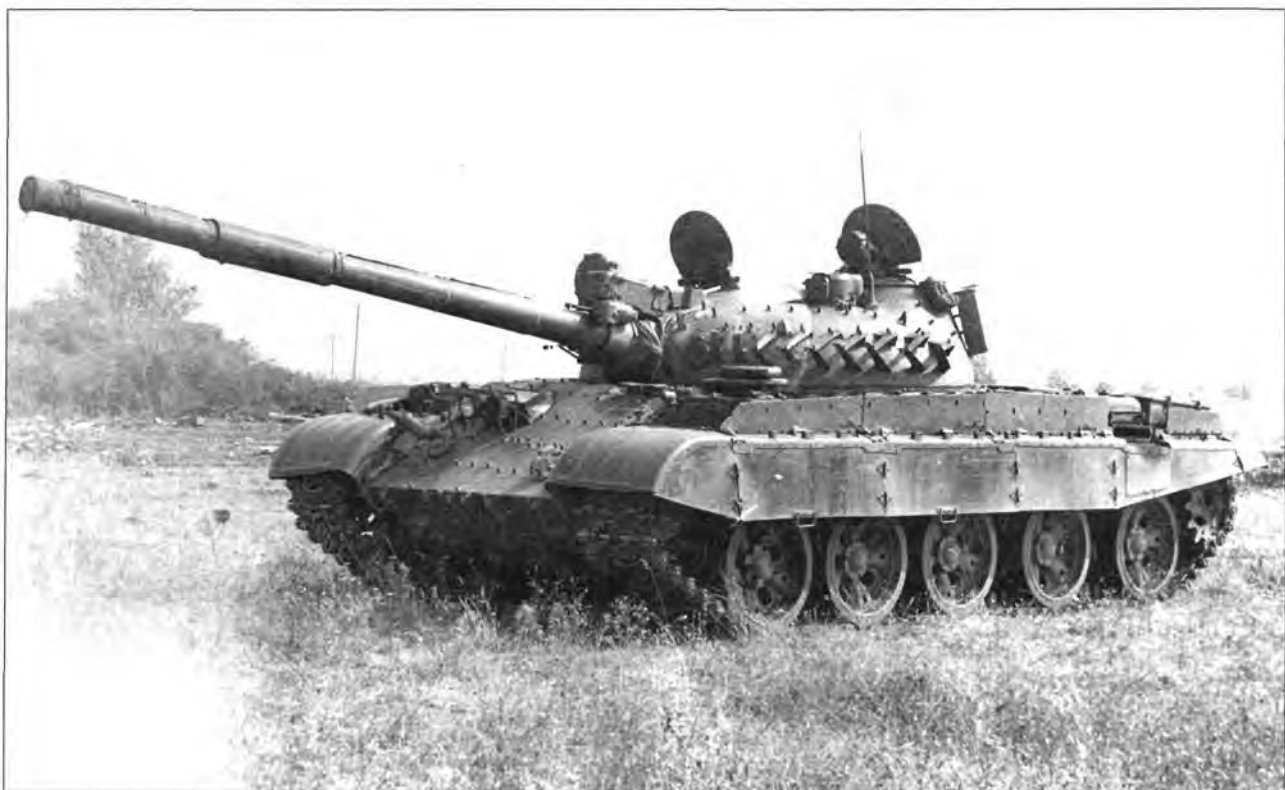
Средний танк Т-62МВ (элементы навесной ДЗ не установлены)
