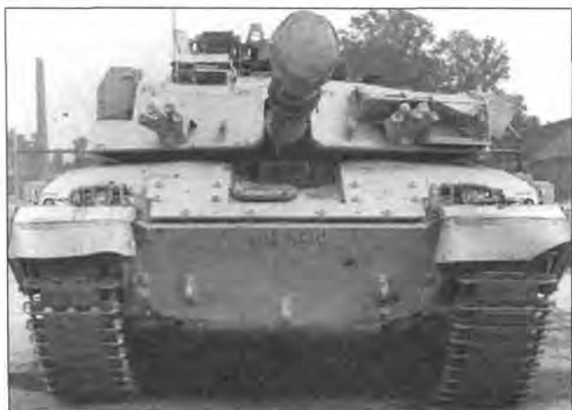
Challenger 1 Mk 3, вид спереди. Хорошо видна накладная броня на верхнем лобовом листе корпуса
