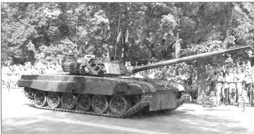
Основной боевой танк PT-91 перед парадом. Варшава, август 2007 года (вверху и слева). Хорошо видны асфальтоходные гусеницы
