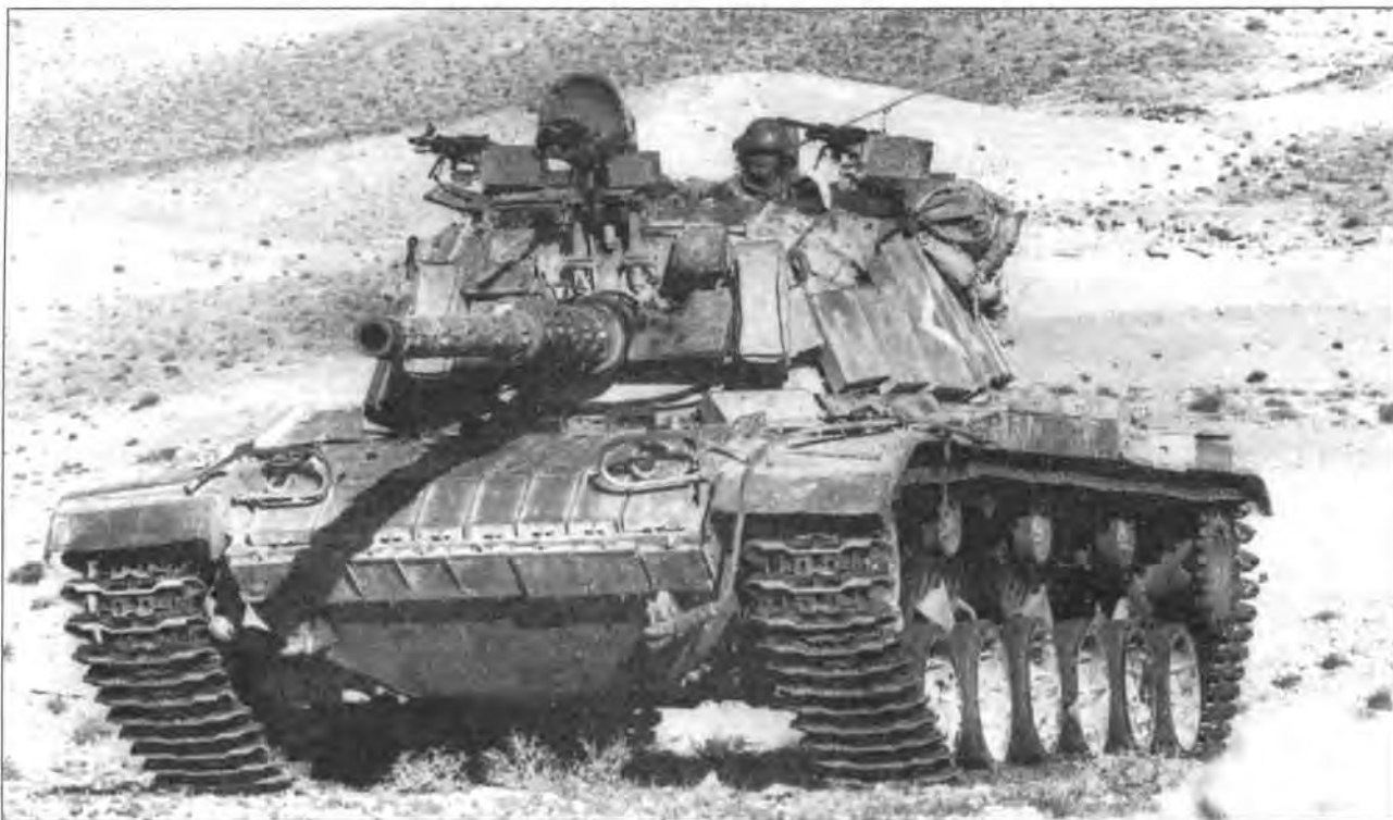
Magach-6 Bet Gal. Обращают на себя внимание теплозащитный кожух пушки и гусеницы, заимствованные у танка Merkava
