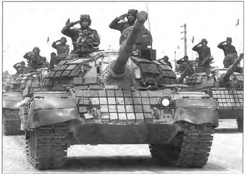
Серийный образец танка Safir-74 с более простым вариантом навесной динамической защиты
