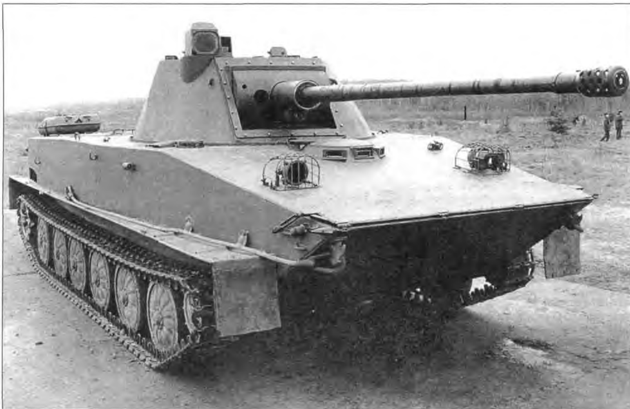
Один из возможных вариантов модернизации танка ПТ-76 путем установки новой башни с 57-мм автоматической пушкой
