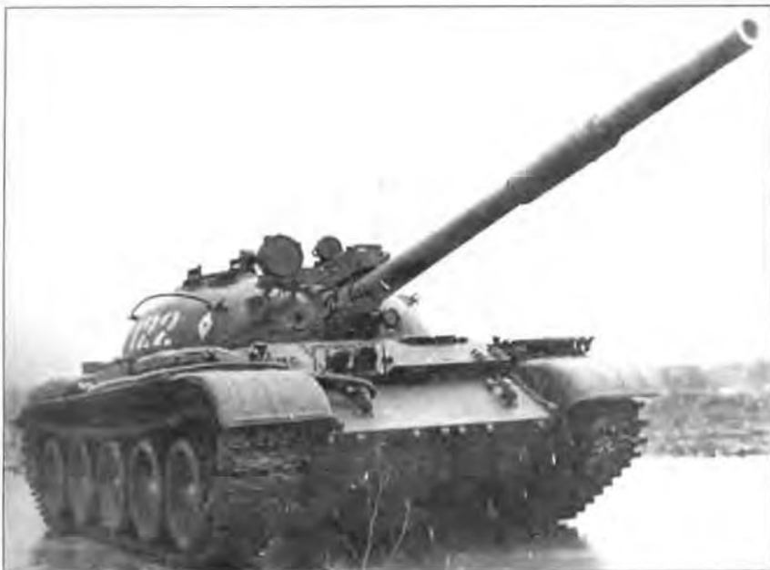
Средний танк Т-62, оснащенный лазерным дальномером КДТ-1 (слева). Установка лазерного дальномера КДТ-1 на танке Т-62 (внизу)
