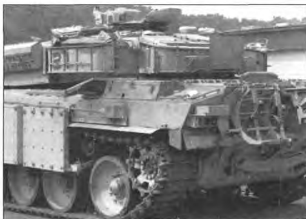
Challenger 1 Mk 3, вид сзади. Видны кронштейны для крепления топливных бочек и дополнительная защита бортов корпуса
