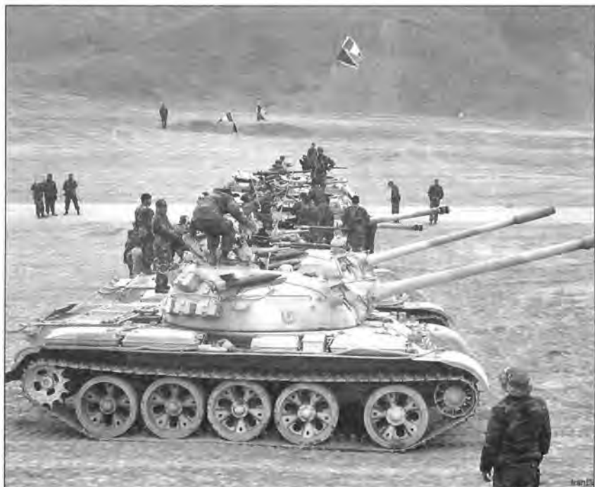
Средние танки Т-55 перуанской армии. Вверху — танк оснащен лазерным дальномером неизвестного типа, внизу — на танках в качестве дополнительного вооружения установлены ПТУР 9М14М «Малютка»
