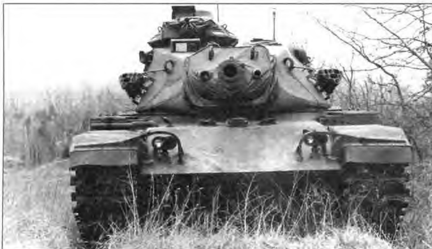
Основной боевой танк М60А3 (справа). Блок дымовых гранатометов на башне танка М60А3 (внизу)
