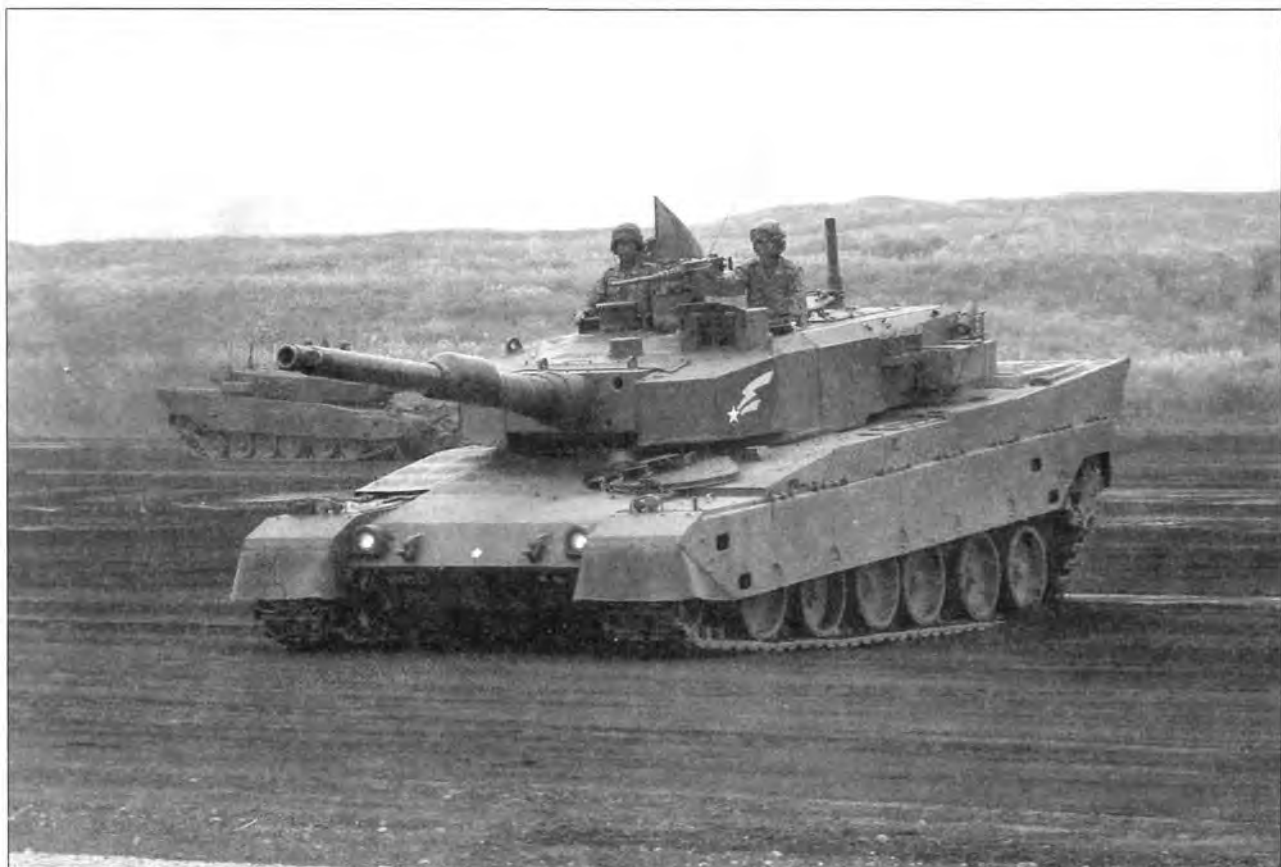
Основной боевой танк «90». Демонстрация возможности гидропневматических элементов подвески
