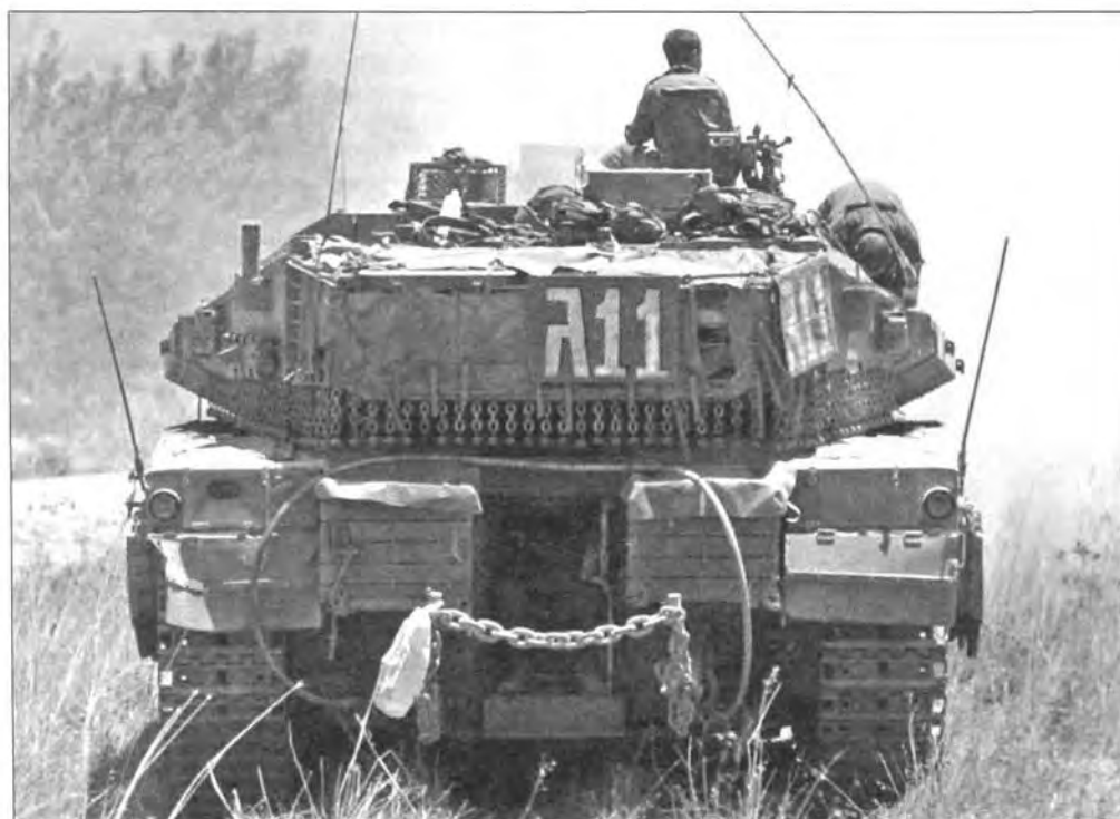
Основной боевой танк Merkava Mk 4. Хорошо видна измененная форма крыши МТО (вверху). На виде сзади (слева) обращает на себя внимание открытая кормовая дверь
