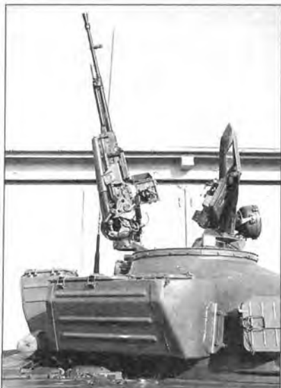
С л е в а: зенитно-пулеметная установка на максимальном угле возвышения: +75°
