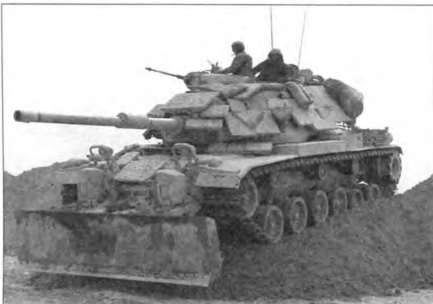
Танки М60А3, оснащенные навесной динамической защитой (вверху и слева)
