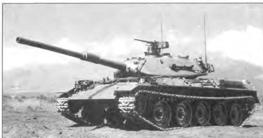
Основные боевые танки «74» во время учений. У танка на фото справа не установлен ИК-осветитель ночного прицела
