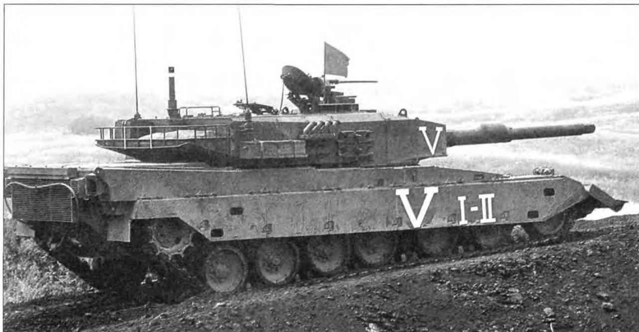
Основной боевой танк «90». Демонстрация возможности гидропневматических элементов подвески
