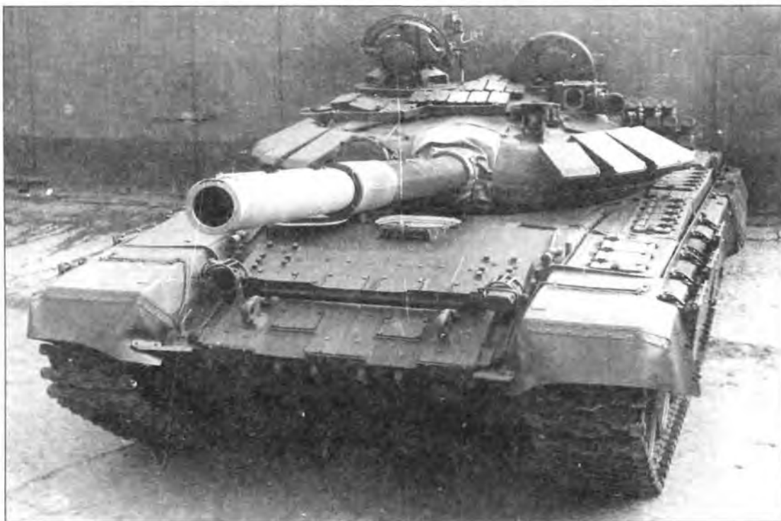
Основной танк Т-72БМ со встроенной динамической защитой (слева). Танки Т-72С во время парада в Москве. 9 мая 1995 года (фото на стр. 255)
