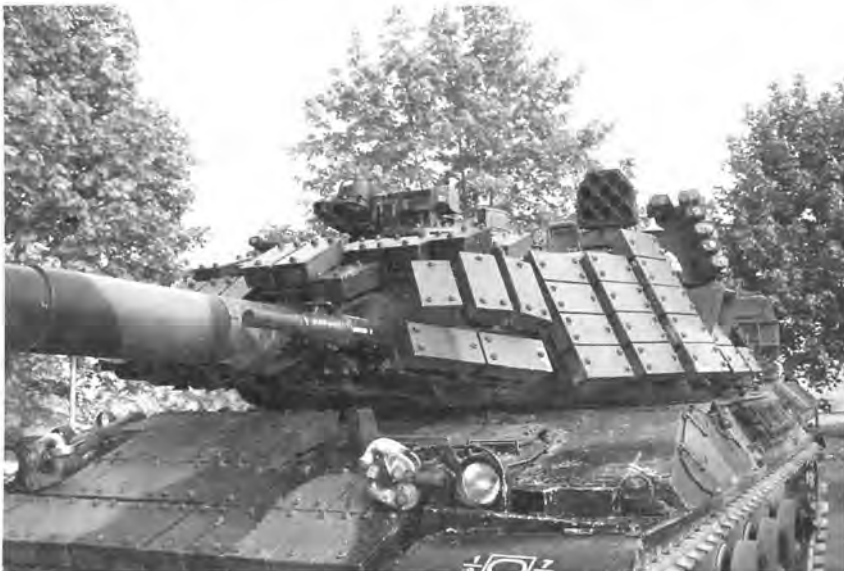
Вид сверху и крупный план танка AMX-30B2, оснащенного навесной ДЗ (вверху и слева)
