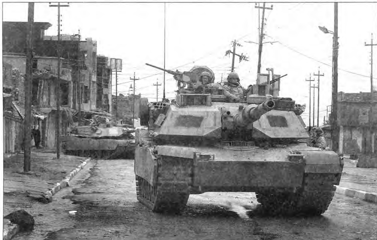
Танки Abrams в Ираке. M1A1 с колейным ножевым минным тралом (вверху). M1A2 в патруле на улице иракского города. Обращает на себя внимание щит пулемета, выполненный из бронестекла (внизу)
