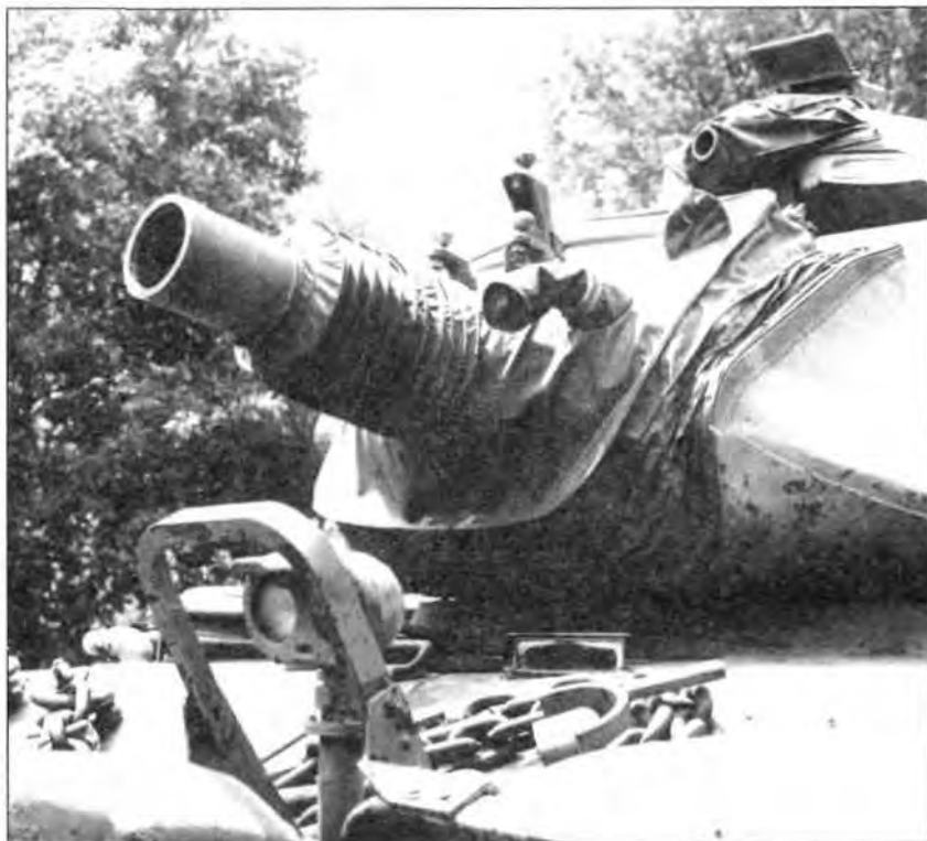
Саперный танк М728 (вверху). 165-мм орудие М135, установленное в башне саперного танка М728 (справа)
