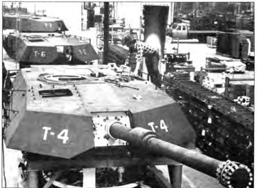
Сборка башен танков Abrams на производственной линии завода Lima Tank Plant
