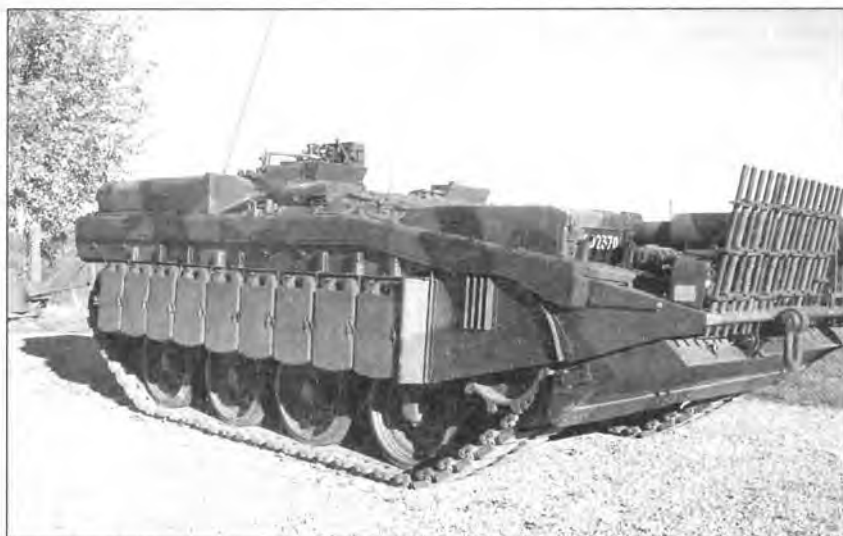
Основной боевой танк Strv-103С. Хорошо видна дополнительная защита из канистр с топливом, размещенных на бортах корпуса
