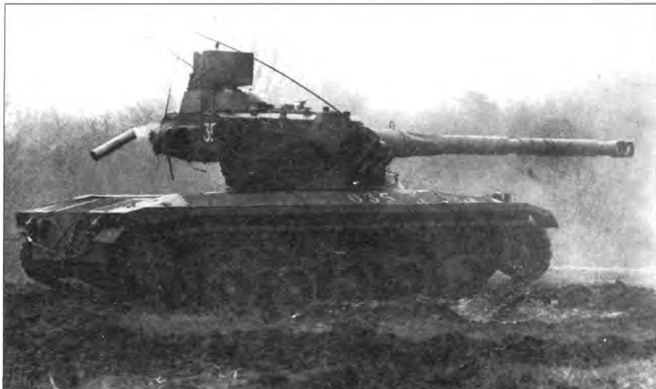
Танки SK105 австрийской армии на учениях. На верхнем снимке хорошо виден выброс гильзы после выстрела
