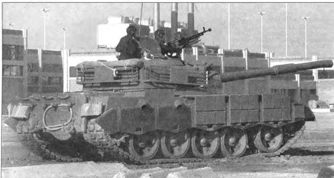
Основной боевой танк Al Zarrar с первым вариантом дополнительной бронезащиты (вверху). По правому борту хорошо видны загнутые вниз выхлопные патрубки. Второй вариант танка Al Zarrar во время парада в Карачи (в центре). Основной боевой танк Al Zarrar с третьим вариантом дополнительного бронирования (внизу)
