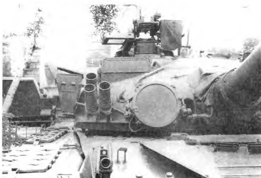
Т-80Б в экспозиции Центрального музея Вооруженных сил в Москве (вверху). Башня танка Т-80Б спереди слева. Хорошо видны ИК-осветитель Л-4А, дымовые гранатометы, антенный блок ГН-12 КУВ «Кобра» и амбразура спаренного пулемета ПКТ (справа)
