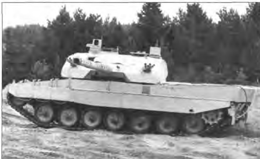
Vickers Mk 7 с башней, развернутой на «девять часов» (вверху слева). Прицел PPE Condor (вверху справа)
