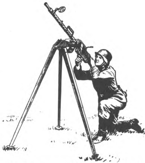
Пулемет, приспособленный для стрельбы по низколетящим целям
